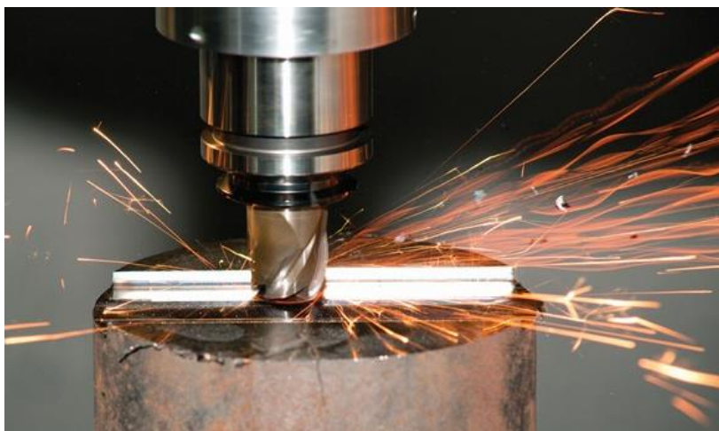
Fresa de cerámica perforando acero
