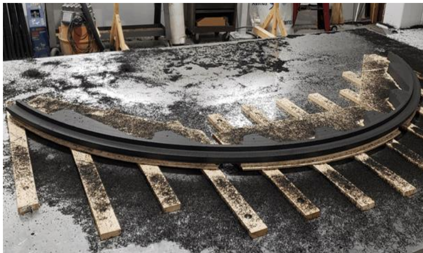
Matriz de estiramiento impresa en 3D después del mecanizado
